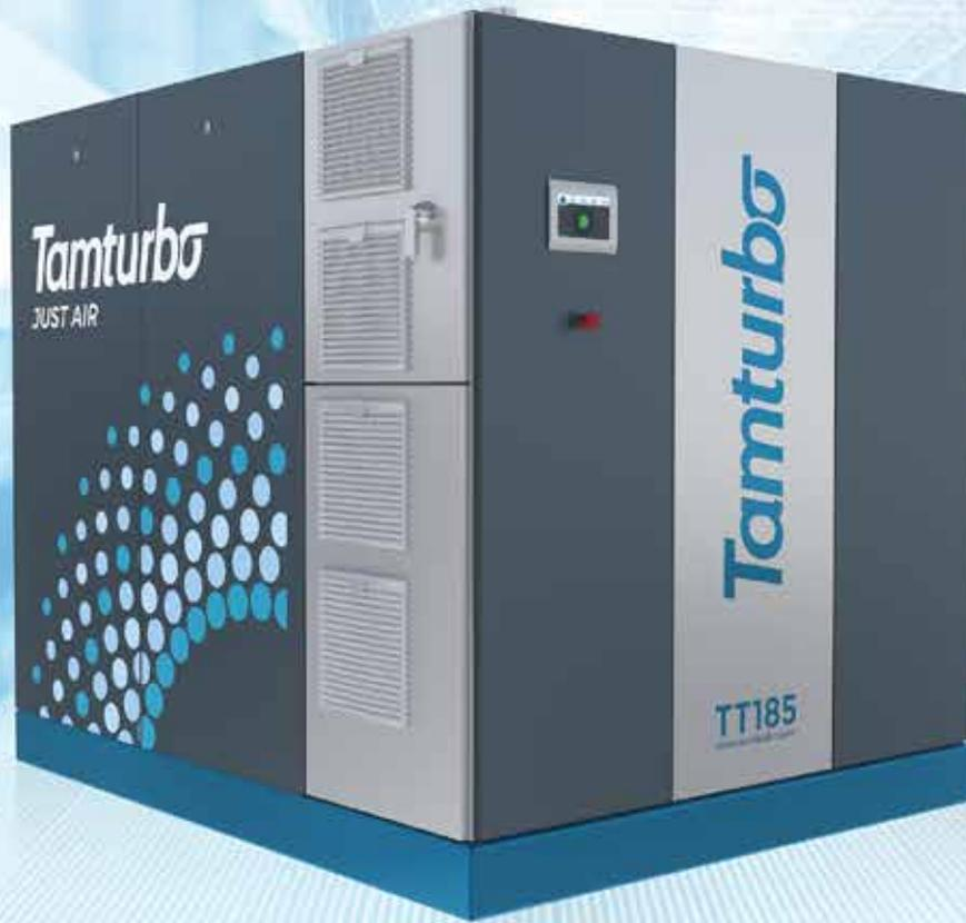
**所有 TAMTURBO® TOUCH-FREE™ 压缩机均为变速控制直驱高速涡轮压缩机，为工业客户生产完全无机油的压缩空气。叶轮直接集成在电机轴上，无需任何联轴器。**
